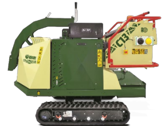
Uitwerppijp en invoertrechter inklapbaar voor transport
